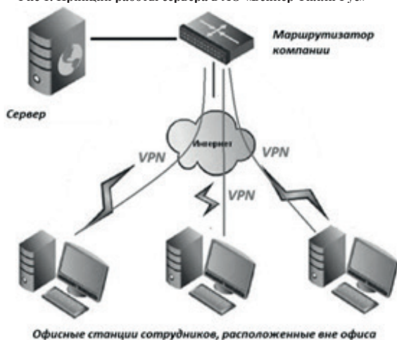
Рис 1. Принцип работы сервера в АО «Бейкер Тилли Рус» 1
